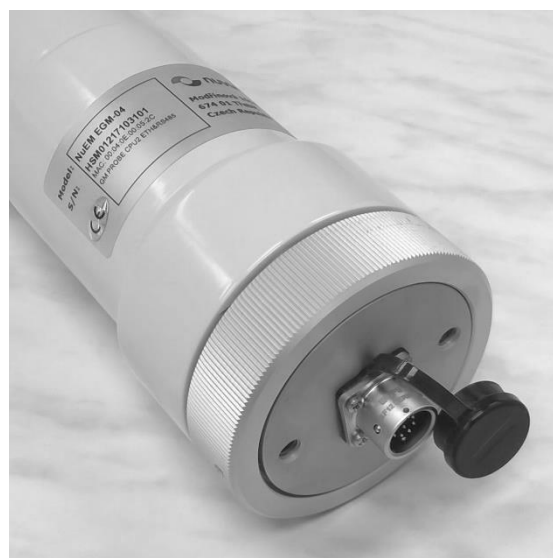
Obr. č. 8 Pripájací konektor sondy NuEM EGM-04
